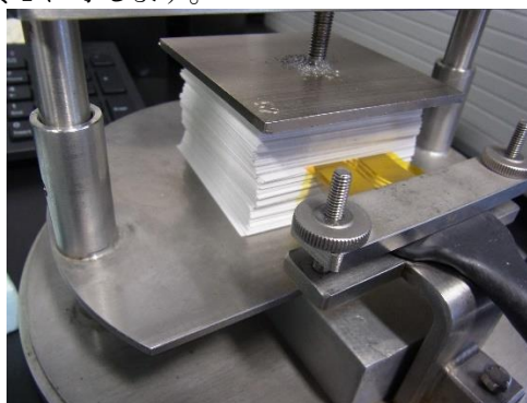
写真1. 異方性測定のセッティング
